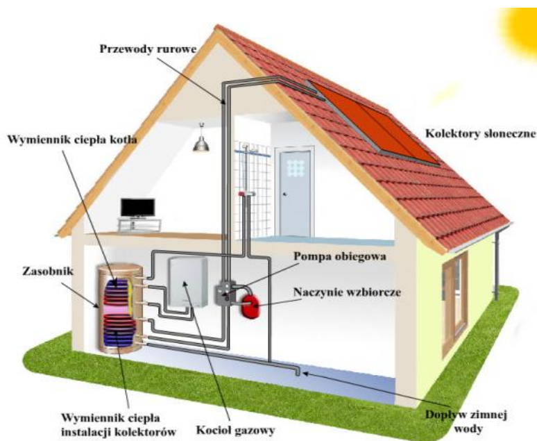
Ryc. 12. Schemat instalacji kolektorów słonecznych w domu jednorodzinnym
